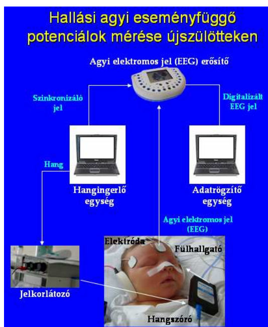
103. ábra: Alvó újszülött csecsemőn elvégzett HAEP mérés elrendezése
