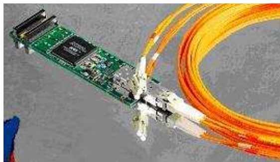
39. ábra: Az adatgyűjtő rendszer DDL linkjei fénykábelrel összekötve
