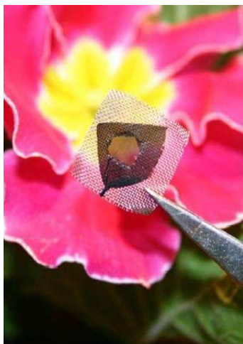
58. ábra: Balra: kb. 100 nm vastagságú, önhordó nanocső vékonyréteg. A minta látható fényre átlátszó. Jobbra: nanocsőhálózat atomerő-mikroszkópos képe
