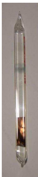
60. ábra: Balra:káliummal adalékolt nanocsőpapír. Jobbra: sav hatására lyukakkal adalékolt nanocsőpapír reflexiójának változása a kezelés hatására
